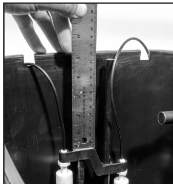
Positionnement de l'interrupteur à flotteur : 12,7 cm du bord supérieur du récipient régulateur
